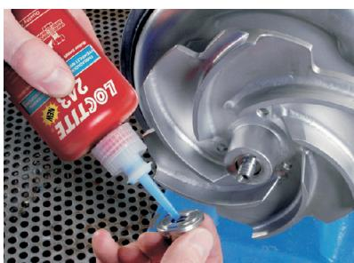
Tecnología desarrollada por LOCTITE, para fijar tornillos, tuercas, espárragos, etc., que se aflojan por cambios térmicos, vibración, impactos, presión,etc.
